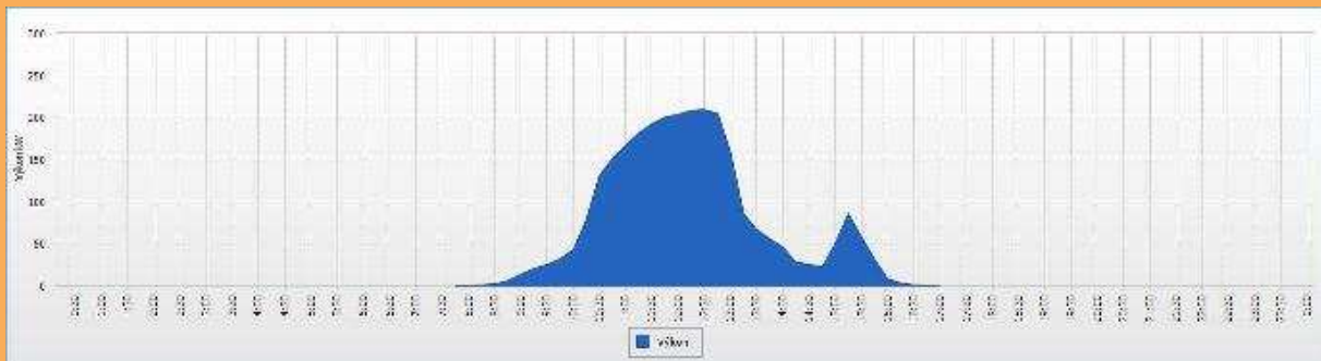
Obr. 2 Monitoring denního průběhu výkonu elektrárny
