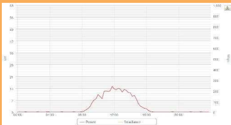
Obr. 8 Monitoring průběhu celkového denního výkonu elektrárny
